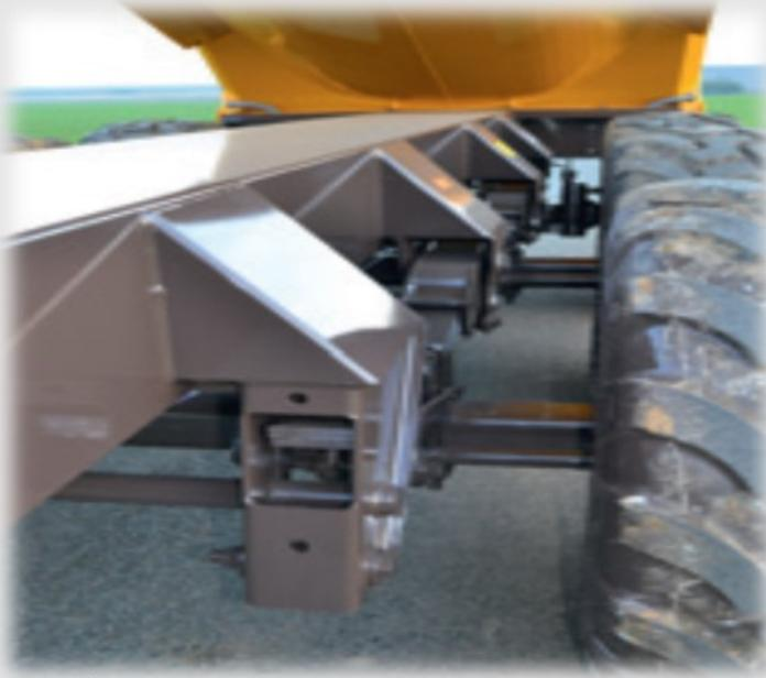
Châssis mono poutre
