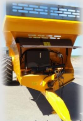
Centrale hydraulique de série commande électrique avec potentiomètre
