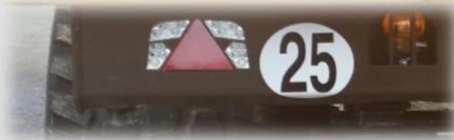
Feux led intégrés dans la poutre arrière
